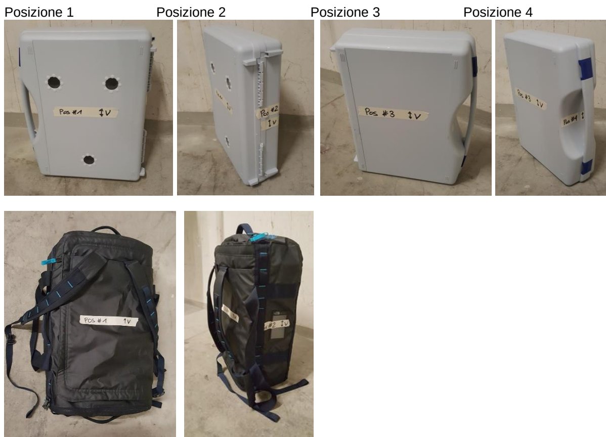
Figura 11: Designazione della custodia di misura di orientamento e dello zaino con definizione della polarizzazione del campo incidente.
