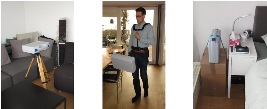
Figura 3: Illustrazione della configurazione di misura per "spot-local" (sinistra), "spot-area" (centro) e "spot-24h" (destra).
